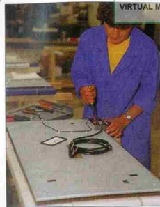
Montage d'un panneau rayonnant mural.
